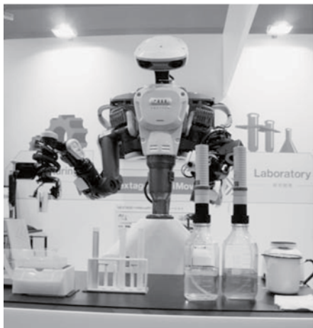
高度な位置制御技術で試験管を的確につかみ作業する
