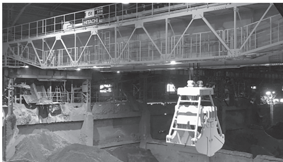
図4 ロープ式セメント原料運搬用 5t × 29m クレーン（プレートトラス構造）
