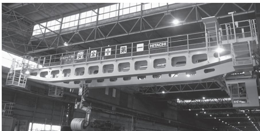
図5 コイル運搬用 21/7.5t × 23.5m クレーン（軽量D型ボックス構造）
